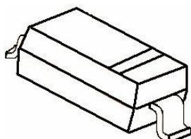
SOD-323 贴片塑封开关二极管
