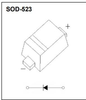
**SOD-523 贴片塑封二极管
